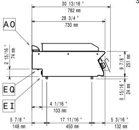
Electrical inlet (power) **Equipotential screw**
